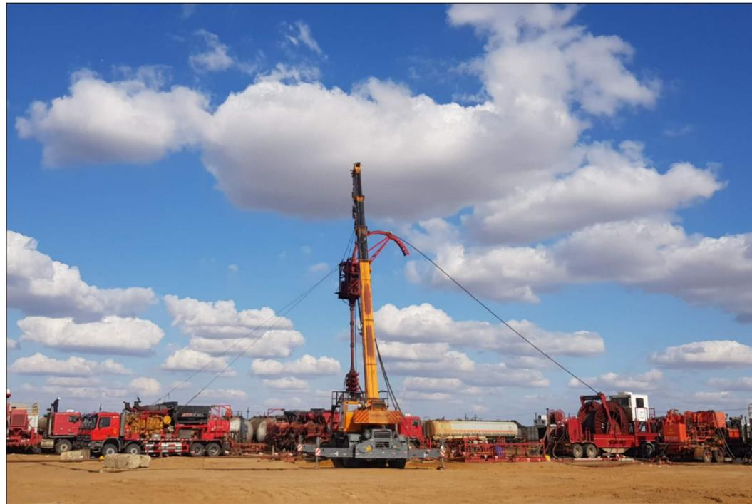
Скоростной трубчатой колонны комплекта высаженных насосно-компрессорных труб
